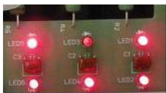
Рис. 2-13 Пример индикации LED при обрыве V фазы модуля питания.
