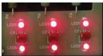
Рис. 2-11 Индикация LED при нормальном выходе инвертора.
