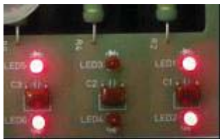
Рис. 2-12 Индикация LED при обрыве V фазы.
